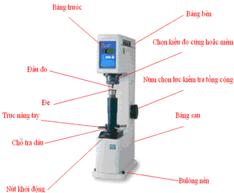
Hình 4. Máy đo độ cứng ROCKWELL-ATK-600.
